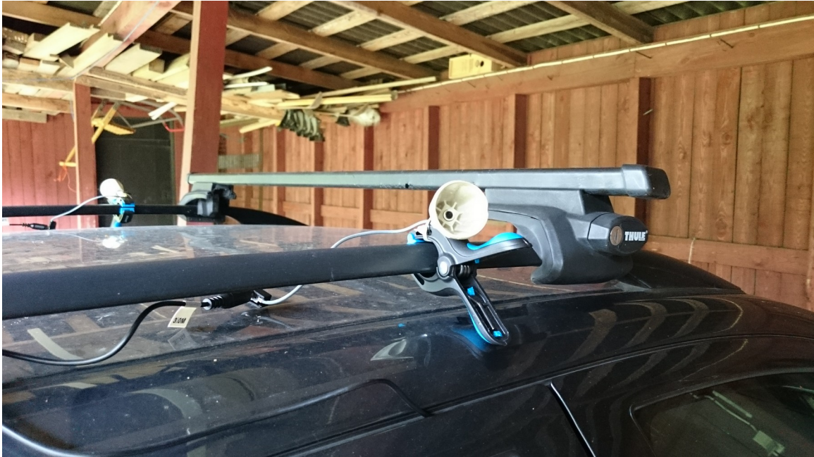
Kuva 2. Auton katolle sijoitetut mikrofonit tuulisuojiin.
