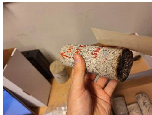
Kuva 12. Näyte HA22. Betonisokkelin sisäpinnan sively ei sisällä asbestia.
