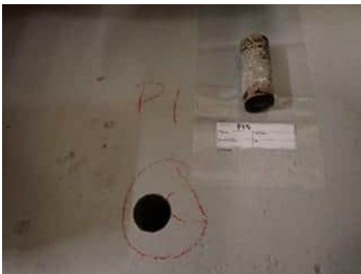
Kuva 18. Näyte P15, tehdassalin eteläpääty. Alapohjan bitumikermi sisältää antofylliittiasbestia ja sen PAH(16)-yhdistepitoisuudet ylittävät vaarallisen jätteen raja-arvot.
