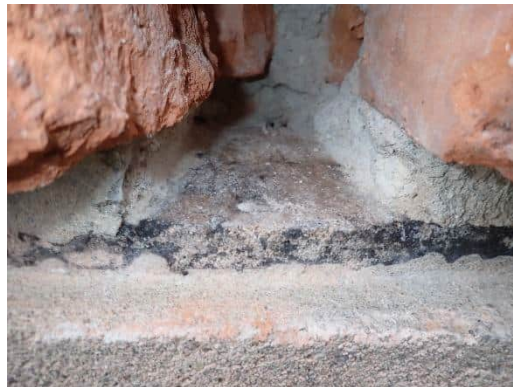
Kuva 16. Näyte HA28. Betonisokkelin yläpinnan bitumisiveley ei sisällä asbestia eikä sen PAH(16)-yhdistepitoisuudet ylitä vaarallisen jätteen raja-arvoja.
