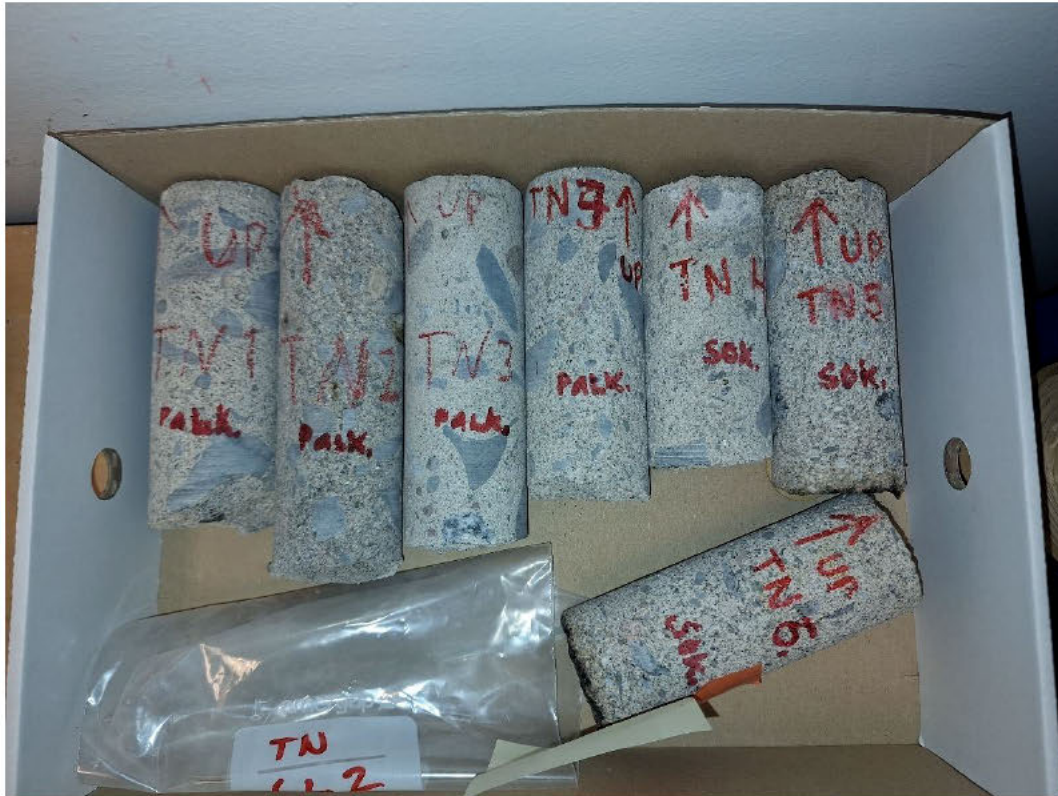
Kuva 42. Valokuva poralieriönäytteistä. Kuvassa näkyvä näyte TN7 oli ylimääräinen, eikä sille tehty laboratorioanalyysijä.
