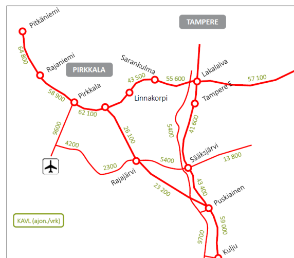
Kuva 4. V1.2 laskentavaihtoehdon mukaiset tielinjaukset sekä liikennemäärät. [14, kuva 15.10]
