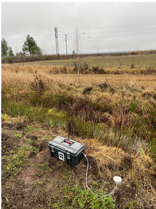
Kuva 1. Periaatteellinen kuva mittapistestä. Kuvassa näkyy tiedonkeruu- ja kommunikointiyksikkö ja maahan maapiikeillä kiinnitetty anturi.
