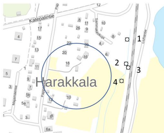
Kuva 6 Kaava-alueen läheisyydestä tehtyjen siipikairausten tutkimuspisteet ja leikkauslujuustulokset, taulukossa esitetty alhaisin leikkauslujuuden ( \text{kN/m}^2 ) arvo. Aineistot: GTK:n avoimet paikkatietoaineistot, Pohjatutkimukset © Geologian tutkimuskeskus 11/2021, MML:n avoimet paikkatietoaineistot, Maanmittauslaitoksen taustakartta, © Maanmittauslaitos 11/2021
