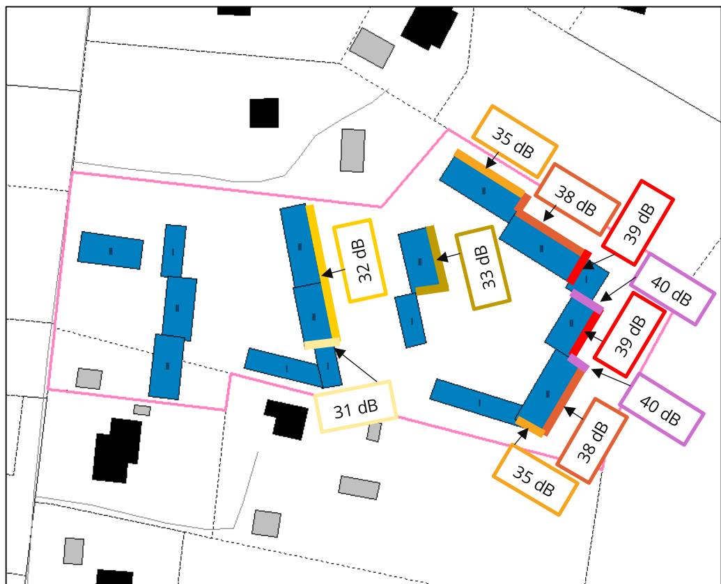
Kuva 4. Suositukset kaavamääräyksistä asuinrakennusten julkisivujen ulkovaipan kokonaisääneneristävydestä julkisivuille, joilla hetkellinen enimmäisäänitaso L_{Amax} ylittää 75 dB. Muille julkisivuille normaali ulkovaipan ääneneristävyys (30 dB) on riittävä.
