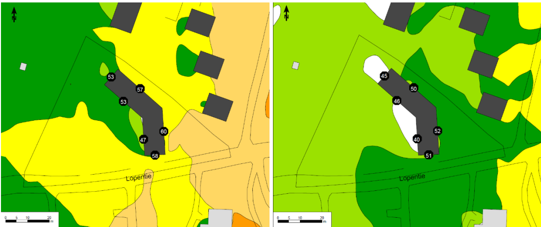
Kuvat. Lopentie 10-12 sijaitsee lähellä Tampere-Helsinki moottoritietä, mikä vaikuttaa alueen melutasoihin. Ohessa on melukartat päivä- ja yömelusta alueella vuonna ennusteena vuonna 2040. Valkoinen väri kuvastaa <45 dB melua, vaaleanvihreä 45-50 dB melua, tummanvihreä 50-55 dB melua, keltainen 55-60 dB melua ja oranssi 60-65 dB melua. Tontille on siis mahdollista muodostaa riittävästi melulta suojattua ulkotilaa.
